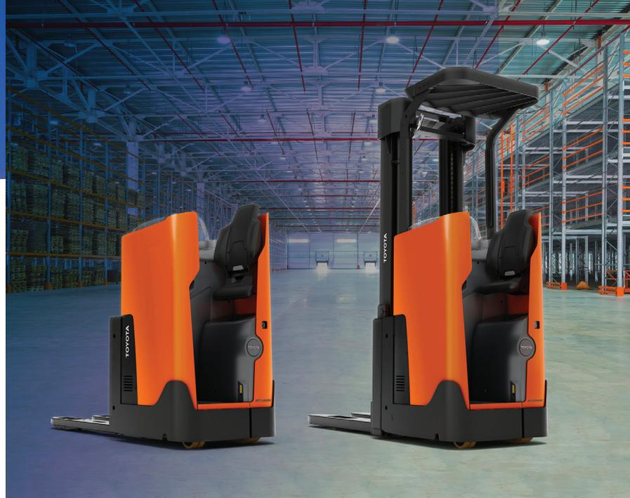
**LSI200**, transpallet elettrico guida in piedi da 2t, il **Toyota BT Staxio SSI200D**, stoccatore guida in piedi da 2t per il doppio impilamento e il **Toyota BT Staxio SSI160N** un carrello elevatore guida in piedi per corsie strette da 1,6 t con bracci di supporto elevabili.
